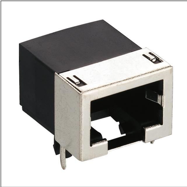
Modular-Einbaukupplung, 8p8c (RJ45), abgewinkelt, mit Schirmung, untenliegender Verriegelung und Flansch, für Leiterplatten
